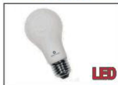
ESTANDAR LED -SMD POTENCIA 6W -LUMENES 600 - VOLTAJE 220V -ANGULO 230° -BASE :E27 COLOR:3000°K 6600°K VIDA UTIL 26,000h DRAF
